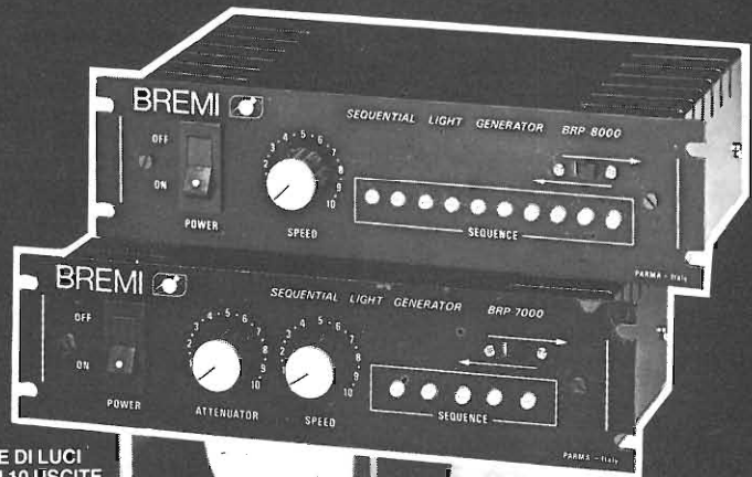
GENERATORE DI LUCI SEQUENZIALI 6 USCITE MOD. BRP 7000
